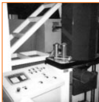
PVC cső ütésállóság vizsgálata 0°C-on
