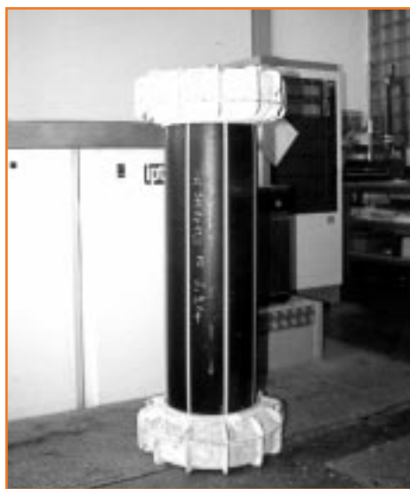
80°C-os tartós belső nyomásállósági vizsgálatra előkészített PE cső próbatest
