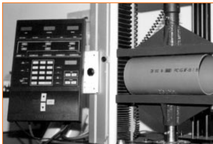
Csatornacső merevség vizsgálata
